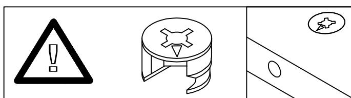
**Markierungspfeil muß zur Bohrung in der Bauteilkante zeigen!**
